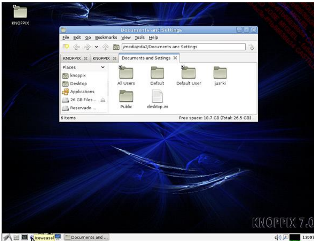
Acceso a una partición de Windows a partir de un Live CD Linux
